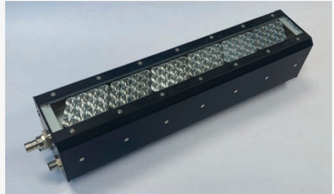
Abb. 8: Demonstrator eines wassergekühlten LED-Strahlers für 72 LEDs der Baureihe OCU-480 oder OMC-747. Dieser Strahler wurde ursprünglich für den Einsatz von UVA-LED entwickelt, ist jedoch für Breitband-LEDs ebenso einsetzbar.
