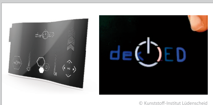
Abbildung 2: Projektdemonstrator mit integrierter OLED und Touchbedienung im Tagdesign (links) und beleuchtetem Schriftzug im Nachtdesign (rechts)
