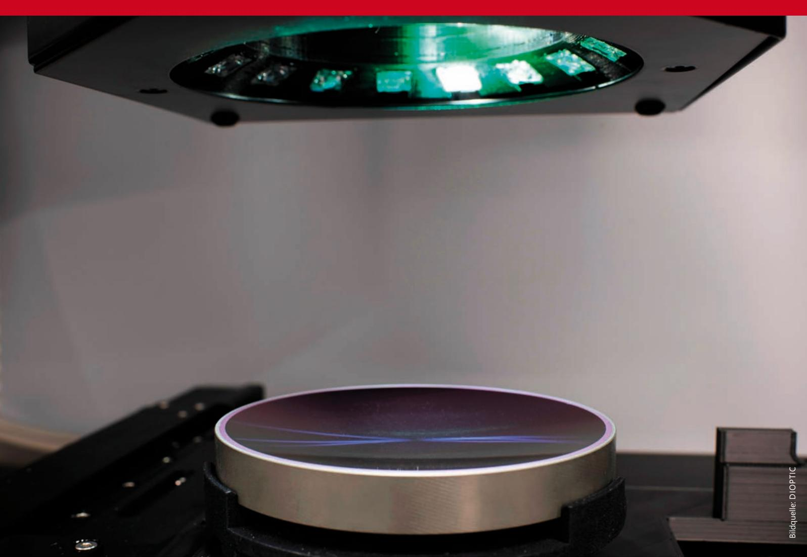
**Oberflächenüberprüfung eines Fokussierspiegels mit ca. 100 mm Durchmesser**
