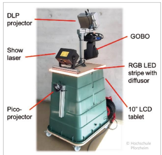
Abbildung 5: Universeller HRI-Demonstrator für Evaluierung und optische Messungen.
