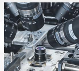
Ausrichten und Testen von Kameramodulen
