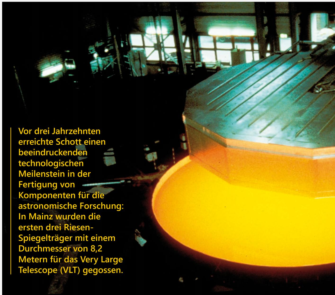
**Vor drei Jahrzehnten erreichte Schott einen beeindruckenden technologischen Meilenstein in der Fertigung von Komponenten für die astronomische Forschung: In Mainz wurden die ersten drei Riesen-Spiegelträger mit einem Durchmesser von 8,2 Metern für das Very Large Telescope (VLT) gegossen.**
