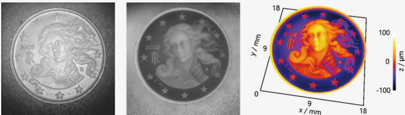
Bild 1: Beispielmessung einer 10-Eurocent-Münze: Links ist das Amplitudenbild zu sehen – vergleichbar mit einer klassischen Fotografie. Das Phasenbild in der Mitte stellt in jedem Pixel die Höheninformation als Grauwert dar. Rechts sind die Messergebnisse in 3D dargestellt. (Quelle: Fraunhofer IPM).
