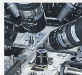
Ausrichten und Testen von Kameramodulen
