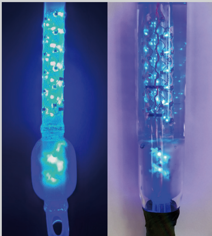
Abb. 3: links: Endotrachealtubus mit 48 integrierten blauen LEDs; rechts: LED-Tubus in Bakterien-Lösung in Glaszylinder (Lufröhren-Modell)
